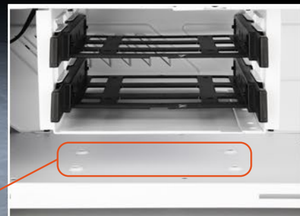
Rendijas de ventilación para refrigeración óptima de las unidades de disco
