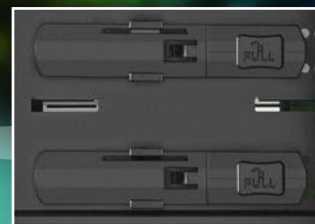
Instalación sin herramientas para dos unidades de disco 5,25"
