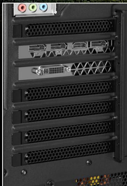
Panel con ranuras de rejilla para una mejor circulación del aire
