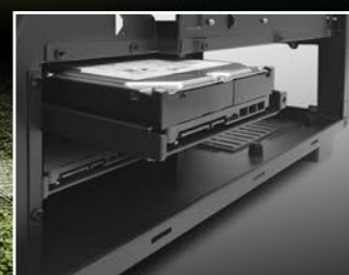
Montaje por separado de tres discos duros 3,5"
