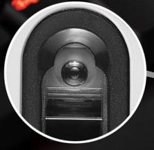
El sensor integrado PixArt 3325 sensor, con hasta 5.000 DPI en siete pasos personalizables, ofrece precisión la precisión necesaria según nuestros propósitos.
