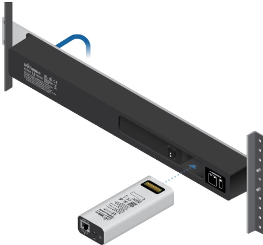
**!** **Advertencia:** Para evitar la creación de un circuito u otro comportamiento desfavorable en la red, solo debería utilizarse una conexión Ethernet. No utilice los puertos Ethernet del Cloud Key G2 y el accesorio de montaje en bastidor al mismo tiempo.
