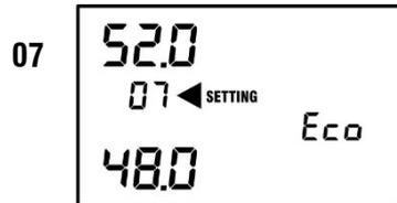
**ECO - RANGO DE ENTRADA DE FRECUENCIA: PARA MODO ECO: En Hz**
