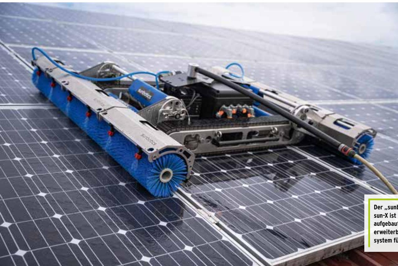
Der „sunbotics“ von sun-X ist ein modular aufgebautes, individuell erweiterbares Reinigungssystem für PV-Anlagen.
