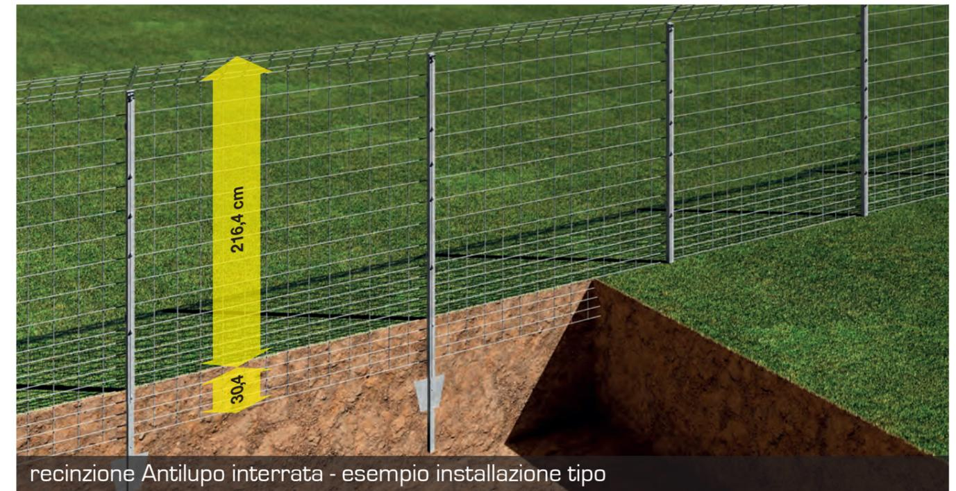
recinzione Antilupo interrata - esempio installazione tipo
