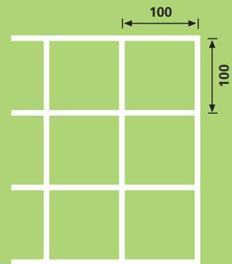
Pavitec HP es producido con un alambre más grueso de aquel utilizado para Pavitec, dando al panel una mayor durabilidad y solidez, proporcionado así la mejor protección contra el movimiento y las grietas consiguientes en los pisos.
