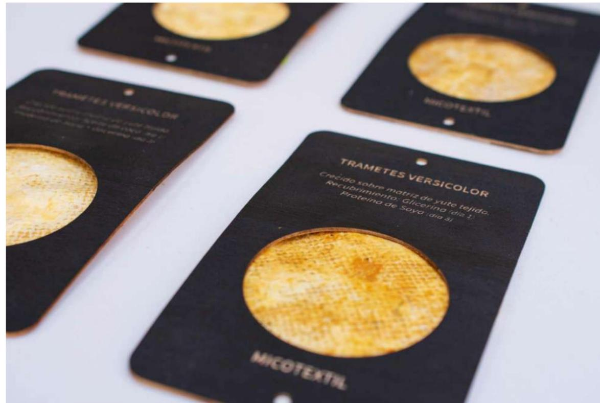
Nuestra aproximación consistió en utilizar una matriz de fibra vegetal (yute) sobre la cual crecer el micelio de los hongos de interés, colectados en el Parte Karukinka. Esta aproximación permite la obtención de estructura, soporte y alimento por parte de la fibra vegetal, permitiendo que el micelio crezca y colonice todo el sustrato de forma más o menos homogénea.
