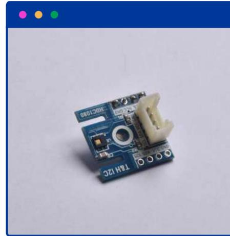
1 Sensor temperatura y humedad HDC1080
