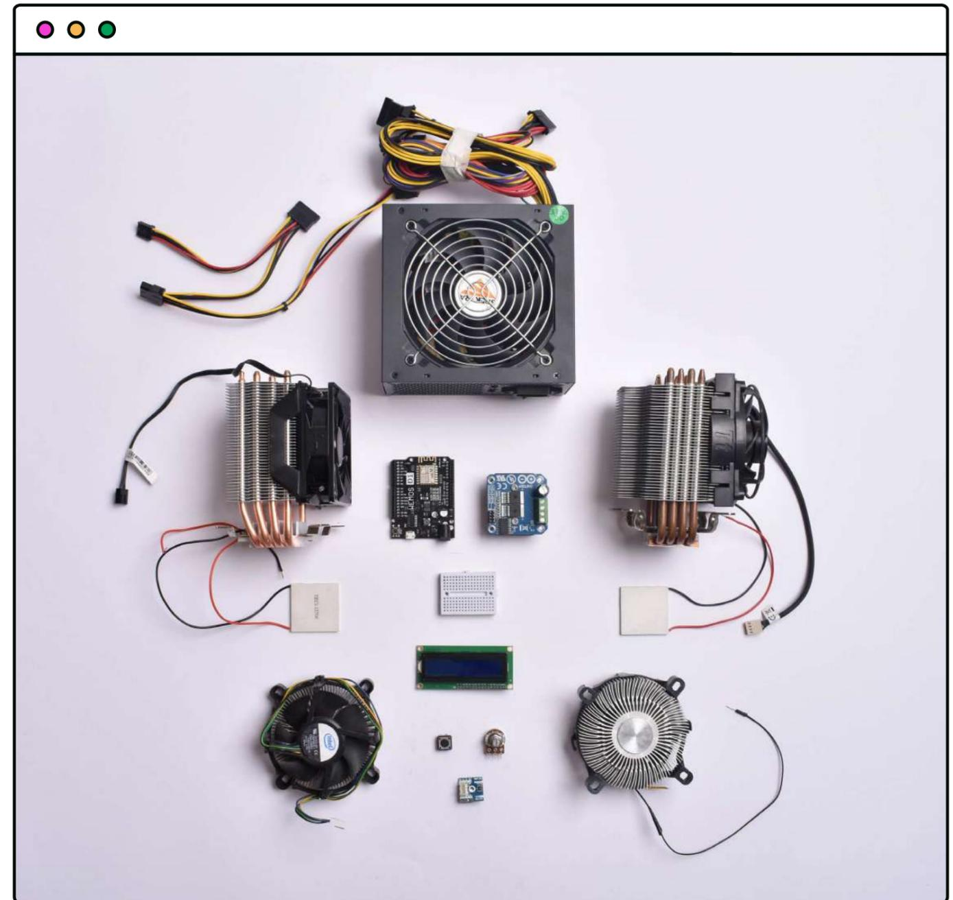
Componentes electrónicos que conforman la Bioincub 1.0
