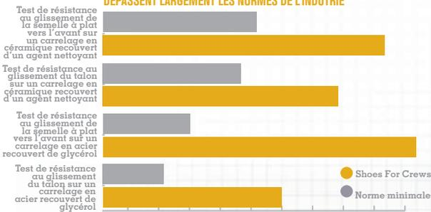
Test EN ISO 13287:2012 pour déterminer la résistance au glissement, effectué par TÜV Rheinland LGA Products GmbH à Leipzig, en Allemagne, en août 2018. \* Sur une échelle où 0,0 correspond à l'absence de friction et 1,0 correspond à une très forte friction (par ex. un tapis sec), SFC a enregistré 0,63, soit plus de trois fois la norme minimale de 0,18. Toutes les chaussures SFC sont équipées de la semelle extérieure antidérapante brevetée Shoes For Crews. Produit testé: DDLCE81 76236
