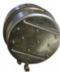
Résistance fixée au corps de chauffe (mais démontable)
