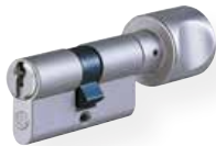
Profil-Knaufzylinder Nr. 815 UDM Messing matt vernickelt eine Seite Schließfunktion, andere Seite Alu-Knauf, F1, diverse Knaufformen erhältlich (abgebildet Form H)
