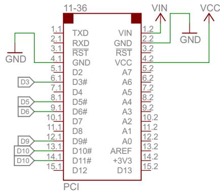
Jumpers de habilitação D3, D5, D6 e D9. Utilizados juntamente com o jumper de seleção para 1 ou 2 motores.
