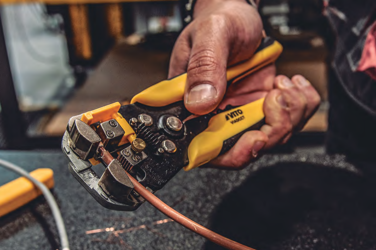
Alicate descarnar cortar e cravar terminais 205 mm
