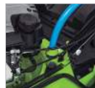
Permite ligação de mangueira para lavagem
