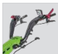
Guiador ajustável e punhos de borracha
