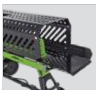
Grade de proteção
