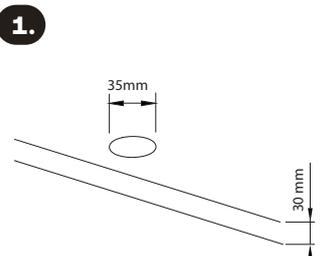
A dimensão do furo é de Ø 35 mm, e a espessura do tampo deverá ser de no máximo 30 mm.
