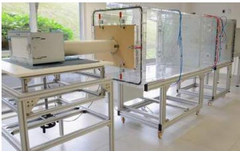
Equipamento para medição da vazão.
