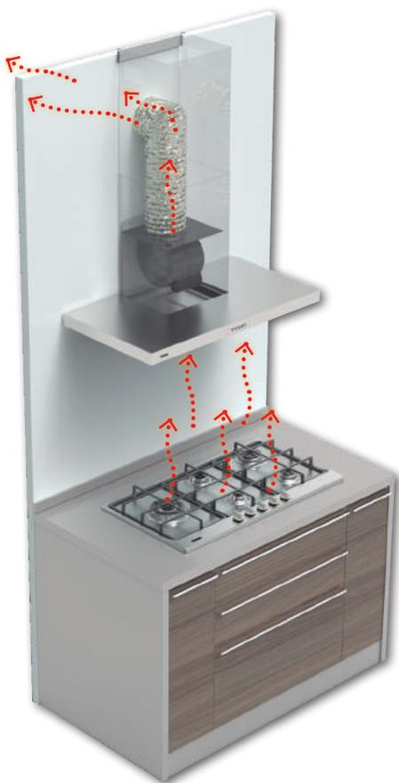
**ATENÇÃO:** A instalação da coifa no modo exaustor exige uma saída externa com diâmetro de 150 mm. Para garantir o melhor desempenho do produto é importante que a tubulação da coifa até a saída externa possua, no máximo, dois metros de distância, com até duas curvas.
