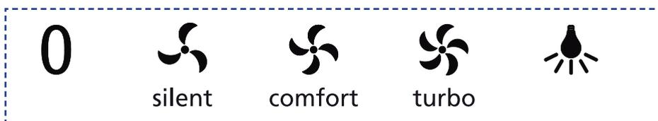
**VEL. 1 - Silent:** Esta velocidade foi desenvolvida priorizando o conforto acústico. Este modo é indicado para fervura de líquidos, cozimento de alimentos em geral (sem fritura) em panelas menores;
