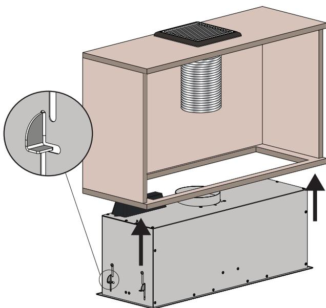
**4** Para instalação da coifa ao móvel, as lâmpadas devem ser retiradas, tendo acesso aos parafusos de fixação
