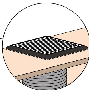
ATENÇÃO: O defletor deve ser instalado juntamente com o tubo flexível de alumínio para direcionar o ar livre de odores de volta à cozinha.
