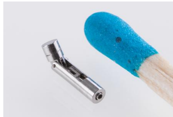
材質：純チタン サイズ：3φ 5mm 加工方法：NC旋盤 部品名：歯科用インプラント部品
