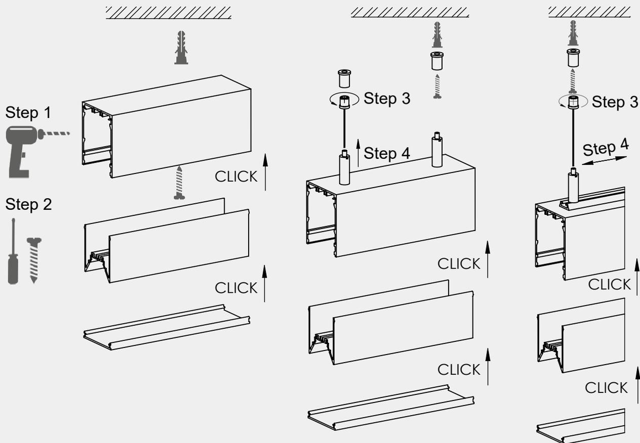
Aussenkanal muss zwingend geerdet werden! Bei Demontage mittels Schraubenzieher die Innenprofile bei den dafür vorgesehenen Bohrungen herunterziehen.
