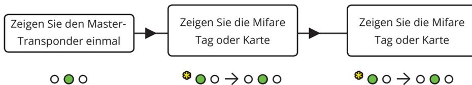
Um die Programmierungsphase zu verlassen, warten Sie 30 Sekunden oder ausgeschaltet Sie die Spannung.
