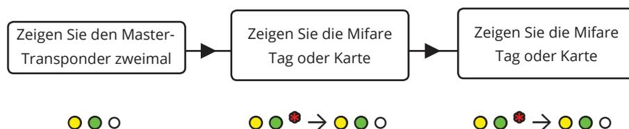
Der M1000-Leser kann auch alle Tags/Karten gleichzeitig löschen, ein verlorenes Tag löschen und den Master-Transponder löschen. Verwenden Sie das mitgelieferte Konfigurationsschema als Anleitung.
