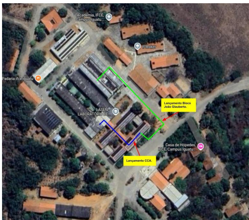
Figura 1. Substituição da fibra óptica no CCA e bloco João Gualberto.
