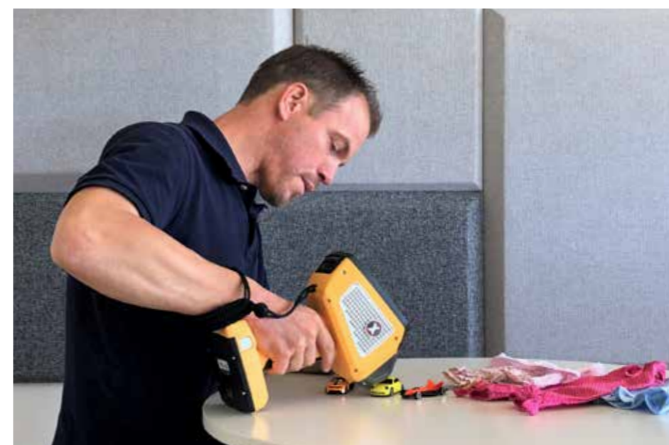
XRF-scannern är ett effektivt verktyg som med hjälp av gammastrålning scannar material i jakt på tungmetaller i metall, plast och textil.
