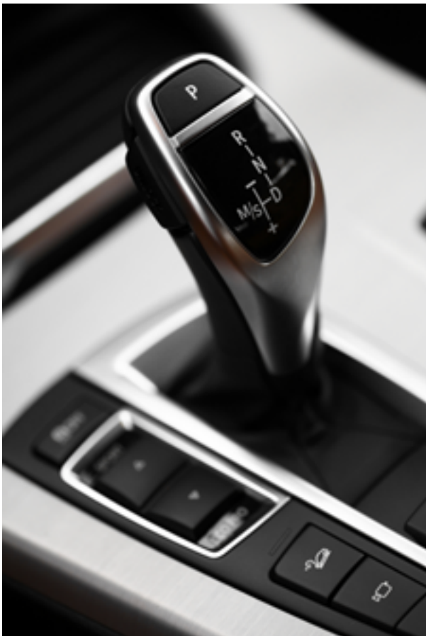
Bild 1: sieht nicht nach Kunststoff aus: metallisierter Gangwahlhebel in einem gehobenen Fahrzeug.
