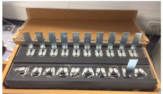
Bild 3: C-Ringe unter Zugspannung nach Beizen mit Inhibierung durch PICKLANE 50 (oben) und ohne Inhibierung (unten)
