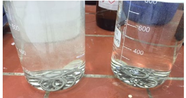
Bild 2: Wasserstoffentwicklung in einer Beize ohne (links) und mit (rechts) PICKLANE 50
