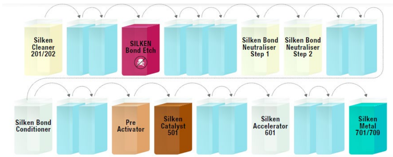
Abbildung 1: Das bei SYNCOTECH entwickelte COVENTYA-Verfahren kann mit geringem Aufwand in die meisten bestehenden Galvanikanlagen integriert werden.
