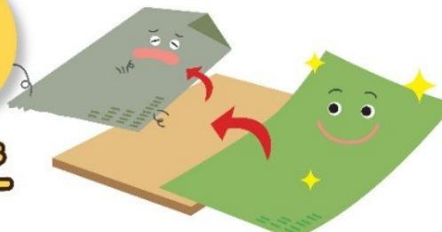
表面が日焼けして、傷み始めたら畳表を裏返しして畳に仕上げる作業です。畳表の傷みが進むと裏返しが出来ない場合があります。
