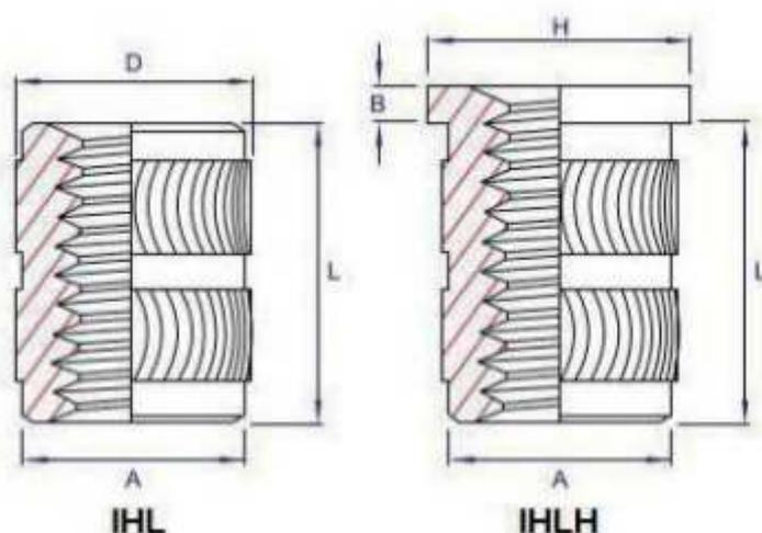
Conçu pour être installé à chaud dans les thermoplastiques amorphes. Sa conception avec des moletages arrondis évite les tensions créées dans ce genre de plastique par les inserts classiques à angles vifs. Il existe aussi une version à tête (5304).
