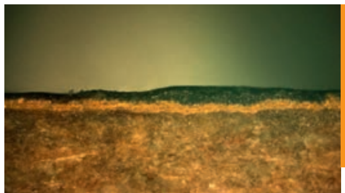
Corte de un laminado con capa útil de overlay, papel decorativo y capa media de HDF, en un microscopio de electrones.
