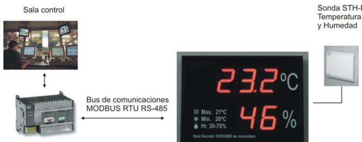
**DTH-C-TCP** cuenta con una sonda externa para facilitar lecturas de la temperatura y humedad local (sonda incluida con cable 5m) y puede transmitir la información de temperatura y humedad a través de un bus de comunicaciones Modbus TCP, así como mostrar los parámetros de temperatura y humedad que se deseen escribir. Incluye cable alimentación.
