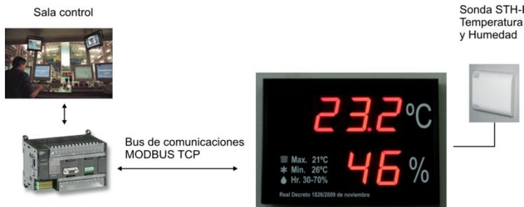
**DTH-EA** permite conectar dos entradas analógicas externas para la temperatura y humedad. Incluye cable alimentación.
