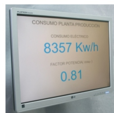
PPA10 con transductor de consumo y factor de potencia.
