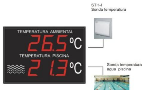
**DTTP-C** cuenta con una sonda externa para facilitar lecturas de la temperatura del interior del recinto de la piscina ( sonda interior incluida con cable 5m ) y otra para la medición de la temperatura del agua ( ver especificaciones ). Puede transmitir la información de temperatura a través de un bus de comunicaciones Modbus RTU RS485 o recibir datos a escribir en la pantalla. Incluye cable alimentación.
