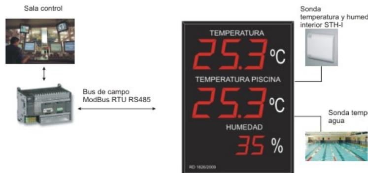
**DTTH -EA** permite conectar dos entradas analógicas externas para la temperatura interior, humedad interior y exterior . Incluye cable alimentación.
