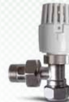
VALVULA TERMOSTATICA DE PRESIÓN PARA RADIADOR Por medio del cabezal termostático se controla independientemente cada radiador de la casa, logrando así un ahorro de energía y un confort personalizado. Sensor termostático por expansión de líquido. En latón niquelado y mando anticorrosivo.
