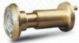
MIRILLA OPTICA CON VISION DE 180° Para puertas de 25 a 38 mm. de grosor. En latón dorado y lentes de cristal. De 14 mm Ø taladro. PEEPHOLE WITH 180° VIEWING ANGLE For 25 to 38 mm. thick doors. In gold plated brass, with glass lens. 14 mm Ø hole.
