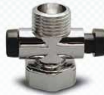
LLAVE DE CIERRE PARA MANGO DUCHA Se intercala entre el mango y el tubo de la ducha. En ABS cromado.
