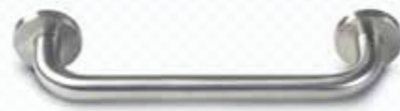
ASA DE SEGURIDAD PARA BAÑO En acero inoxidable. Tornillos ocultos. De 25 cm. de largo. Tubo de 18 mm. Ø. SAFETY HANDLE FOR BATHROOM In stainless-steel. Concealed screws. 25 cm. long. 18 mm. Ø tube.
