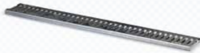
REJA PARA CANAL DE DRENAJE EN ACERO En acero galvanizado. EN 1433 Clase A15 15 KN.
