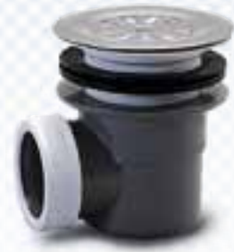
VALVULA SIFONICA REGISTRABLE PARA DUCHA Permite limpiar el sifón sin desmontar. Se puede encolar a tubo PVC o montarla con tuerca convencional. En polipropileno blanco PVC y acero inoxidable de 80 mm. Ø
