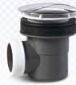
VALVULA SIFONICA DE 80 mm Ø REGISTRABLE PARA DUCHA Permite limpiar el sifón sin desmontar. Se puede encolar a tubo PVC o montarla con tuerca convencional. En polipropileno blanco PVC y ABS cromado.
