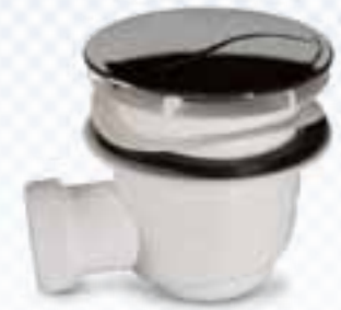
VALVULA SIFONICA DE 115 mm Ø REGISTRABLE PARA DUCHA Permite limpiar el sifón sin desmontar. Se puede encolar a tubo PVC o montarla con tuerca convencional. En polipropileno blanco y ABS cromado.
