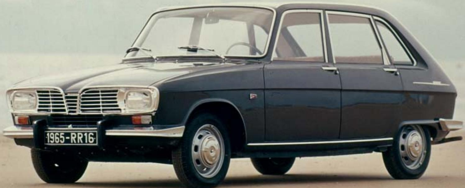
permiten transformar el espacio a voluntad. En el aspecto técnico, el diseñador Yves George también ha innovado: el bloque del motor es de aluminio, el circuito de refrigeración cerrado dispone de ventilación automática, la suspensión de cuatro ruedas independiente utiliza barras de torsión, lo que garantiza un excelente comportamiento en carretera.
