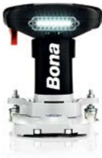
Bona CombiEdge es flexible y se transforma fácilmente en orilladora de brazo corto de 130 mm o de brazo largo de 330 mm. El brazo más largo llega perfectamente bajo zócalos y radiadores. Esta orillera ligera y extraordinariamente eficaz también está equipada con una luz LED frontal que mejora la visibilidad. Para conseguir una retención óptima del polvo es conveniente utilizarla con Bona DCS.
