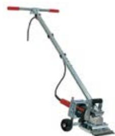
Se puede usar de forma manual o como máquina decapadora de suelos con el manillar extensible. Accionamiento sencillo mediante un interruptor de pedal. Mangos regulables para un fácil ajuste. Se emplea para eliminar revestimientos pegados sobre espuma, materiales textiles, parqué, baldosas semiflexibles o PVC.
