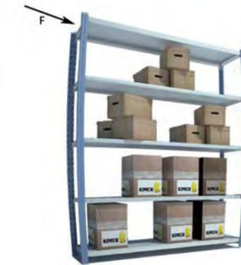
Para el test de capacidad máxima, debe sobrecargarse la estantería, y aplicarse una fuerza en el extremo superior de la estantería, para comprobar la deformación de los puntales.
