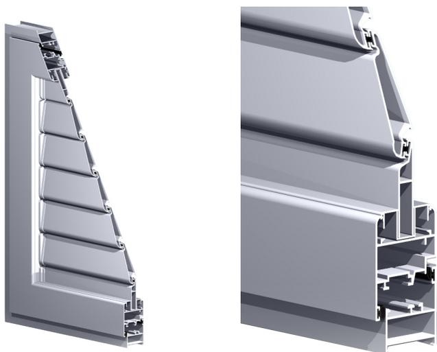
Sistema de protección solar con lamas fijas u orientables que permite la regulación de la luz que incide desde el exterior, garantizando el oscurecimiento deseado y colaborando en la reducción del consumo energético en refrigeración. Así mismo, este cerramiento facilita la ventilación de las estancias evitando su calentamiento por la incidencia solar.
