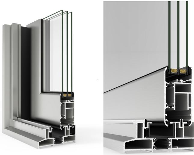
Sistema de corredera con Rotura de Puente Térmico de gran robustez y diseño para posibilitar el cerramiento de grandes huecos de hasta 20 (ancho) x 2,9 (alto) metros en 6 hojas. Existe en dos versiones: corredera elevable y en línea. Presenta soluciones para esquinas a 90° sin parteluces logrando espacios diáfanos para poder disfrutar de la vista exterior.
