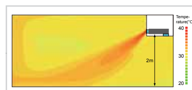
Impulsión de aire con Auto Louver.
