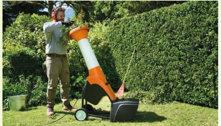
Ein Häcksler zerkleinert Grünschnitt, Blätter und Äste, so dass sie von den Mikroorganismen im Kompost einfacher zersetzt werden können.
