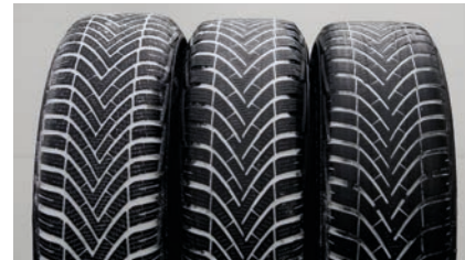
Der gleiche Reifen mit drei verschiedenen Profiltiefen (links neu, Mitte 4 mm, rechts 2 mm)
