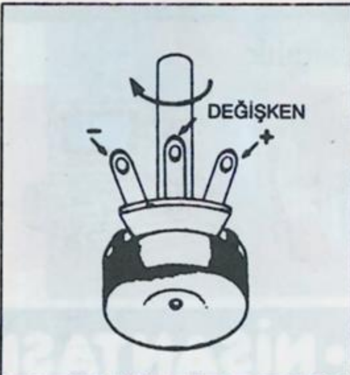
Potansiyometre'nin Standart bağlantısı
