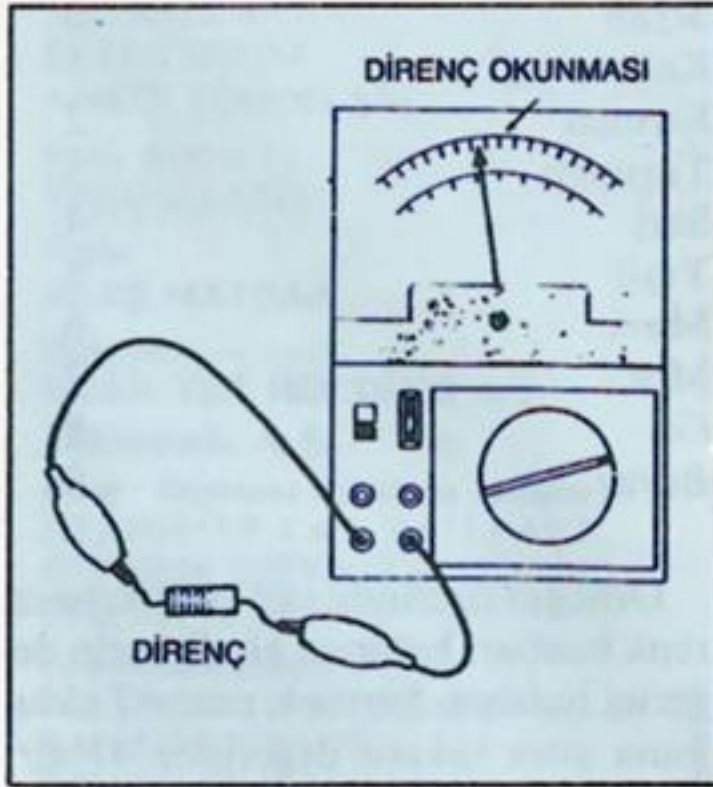
Avometre ile Direnç Ölçümü
