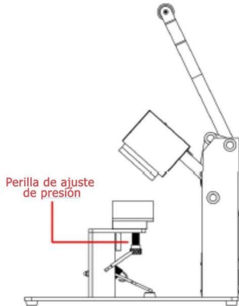
Ajuste la presión girando la perilla en sentido horario para aumentar la presión y en sentido contrario a las agujas del reloj para disminuir la presión.
