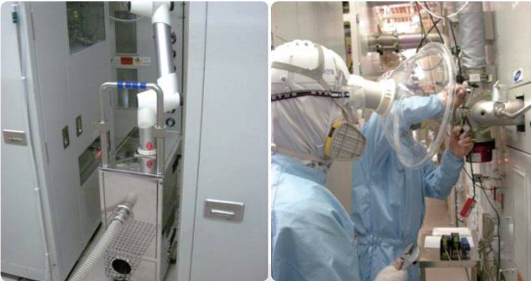
PM작업시 이동식 국소배기장치의 사용 모습
