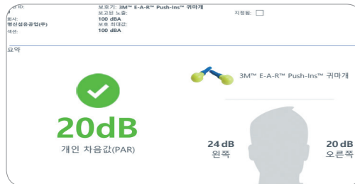
▲ EAR-Fit® 장비를 이용한 귀마개 차음검사의 구조
