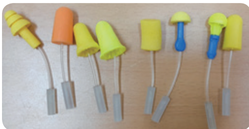
▲ EAR-Fit® 장비를 이용한 귀마개 차음검사의 구조
