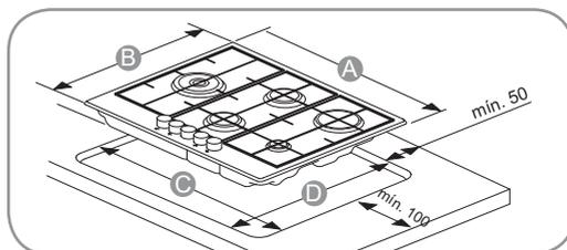
Este produto deve ser instalado em uma bancada de 20mm a 40mm de espessura. Caso haja um forno instalado abaixo do cooktop, um painel deve ser colocado entre os mesmos para evitar danos e proteger o cooktop do calor oriundo do forno. O painel deve cobrir o lado inferior do cooktop e deve ser posicionado de 50mm a 150mm, entre o painel e lado inferior do cooktop.
